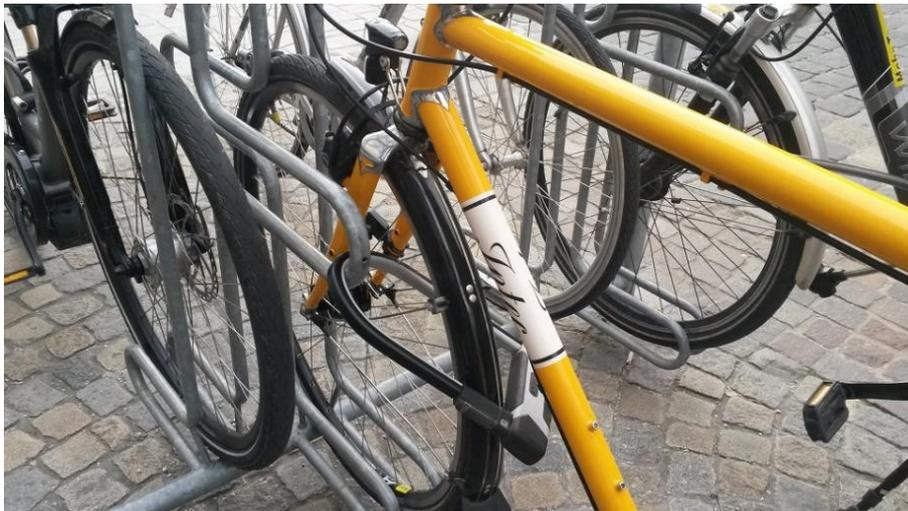
Abbildung 34: Ständer mit Kippschutz, aber zu kurzem Anschleißbügel. Der Fahrradrahmen kann mit einem herkömmlichen Schloss nicht angeschlossen werden.
