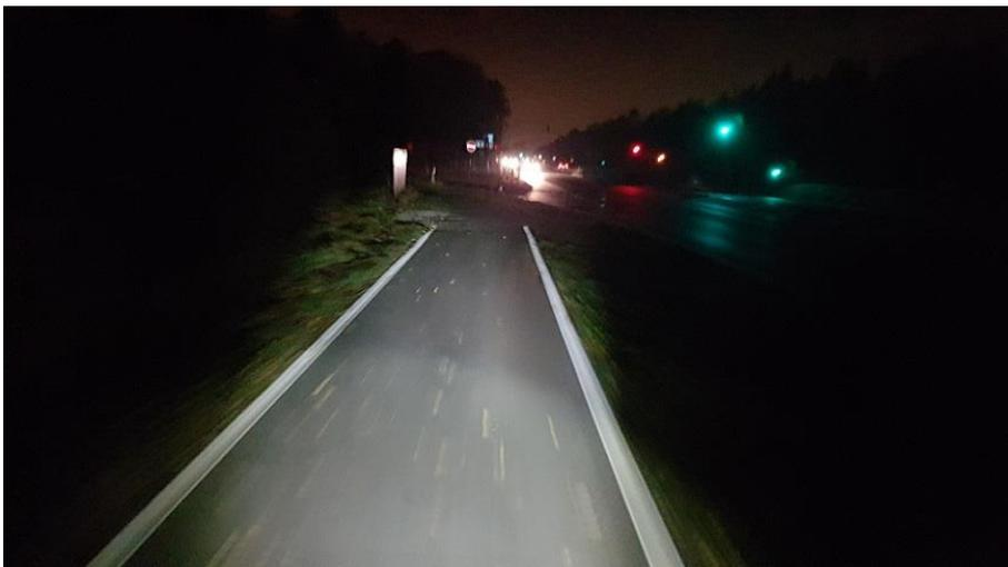
Abbildung 17: Eine weiße Randmarkierung erhöht die Erkennbarkeit der Verkehrsführung gerade bei Dunkelheit erheblich.
