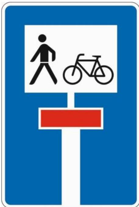
Abbildung 41: Kennzeichnung durchlässiger Sackgassen für Fußgänger und Radfahrer VZ 357-50
