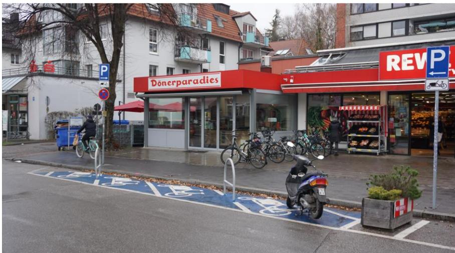
Abbildung 37: Lastenradstellplatz – hier mit kurzem Anlehnbügel
